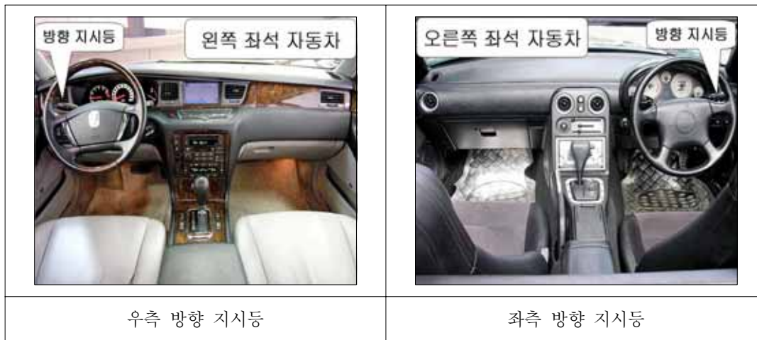
<그림 4-5> 핸들위치에 따른 방향지시등의 위치
